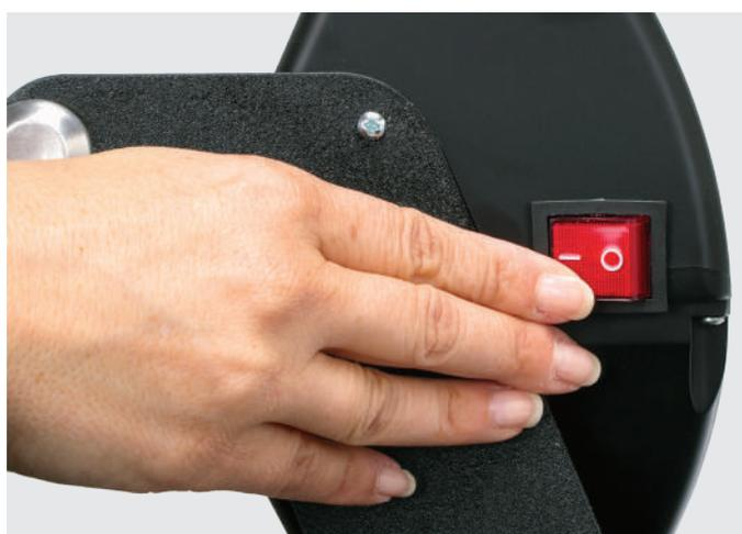
Localisez l'interrupteur marche/arrêt sur le côté de la presse, puis allumez l'interrupteur d'alimentation.
