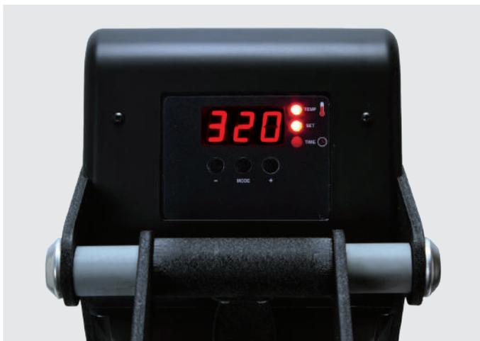
Appuyez sur le bouton de sélection de mode au centre du panneau de commande.
